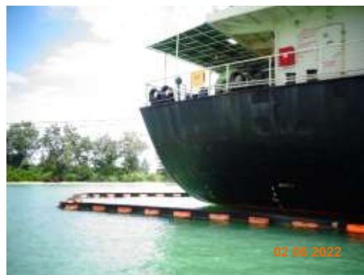
รูปที่ 2-5 (ต่อ) ที่กั้นเพื่อป้องกันการแพร่กระจายน้ำมันในกรณีเกิดการรั่วไหลลงทะเล
